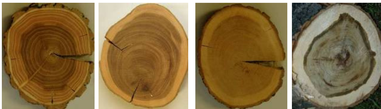
Fot. 5. Porównanie przekrojów drzew z twardziłą zabarwioną: robinia, cis, dąb, topola
