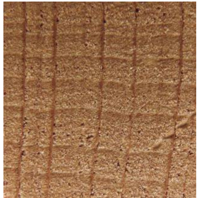
Fot. 2. Przekrój poprzeczny drewna rozpierzchłonaczyniowego - buk
