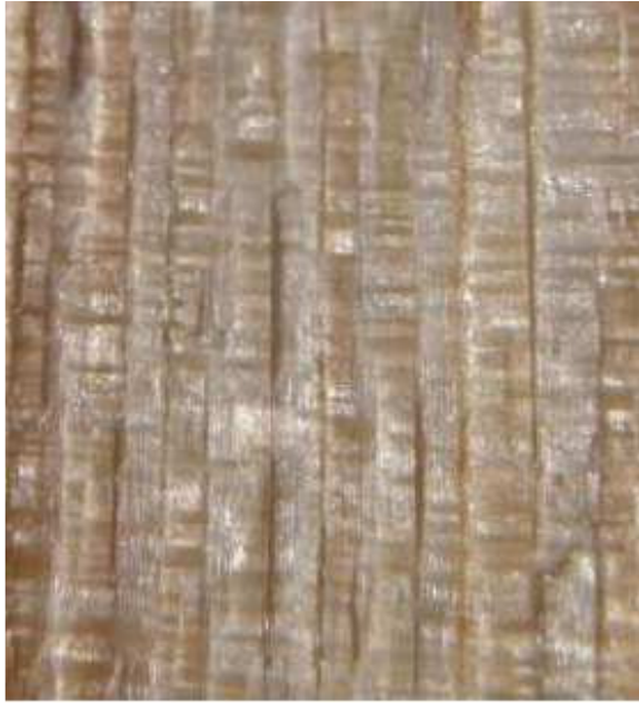
Fot. 5. Przekrój promieniowy drewna sosny
