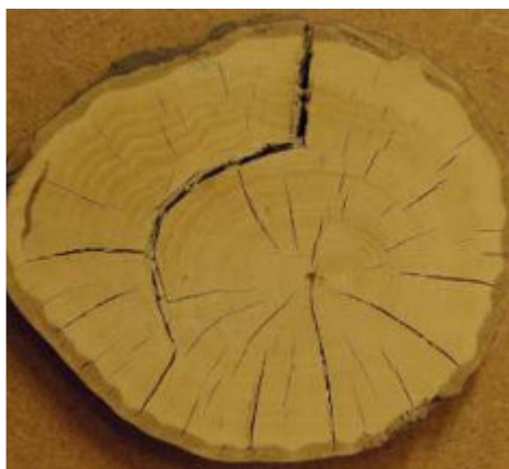
Fot. 9 Pęknięcia proste i okrężne.
