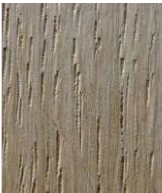
Fot. 11. promienie drzewne na przekroju stycznym drewna dębu
