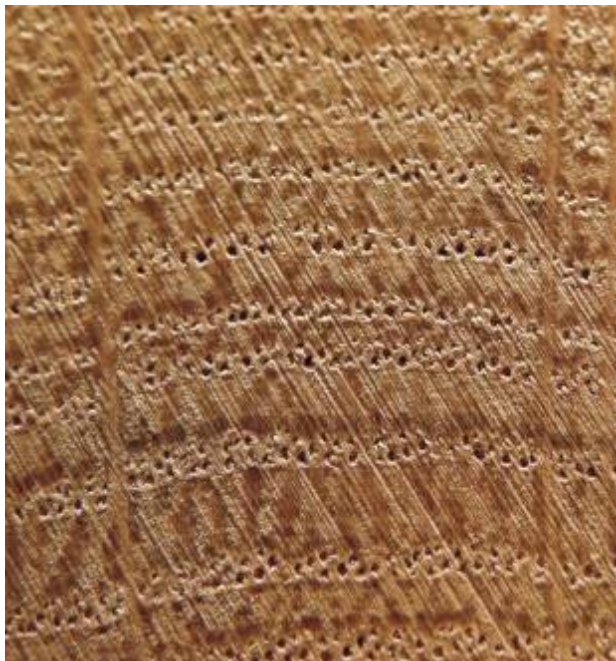
Fot. 1. Przekrój poprzeczny drewna pierścieniowonaczyniowego - dąb
