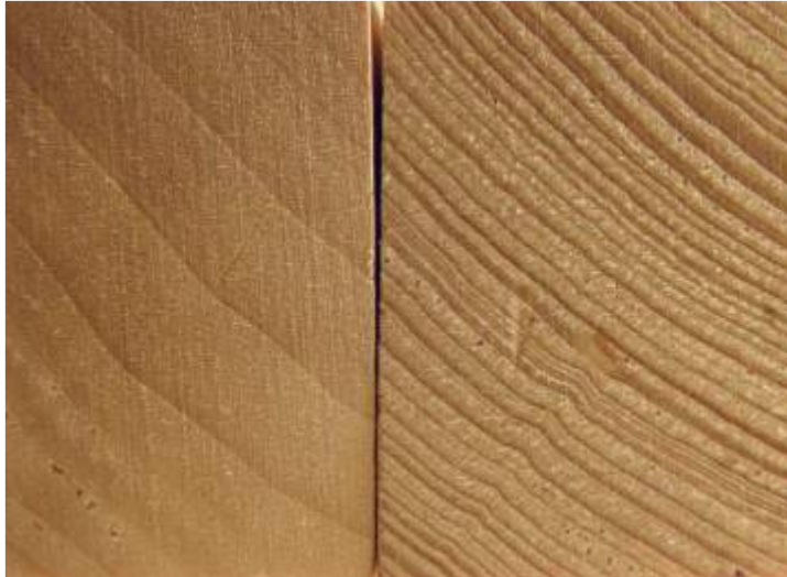
Fot. 3. Różnica szerokości słoików rocznych na przykładzie drewna topoli i świerku
