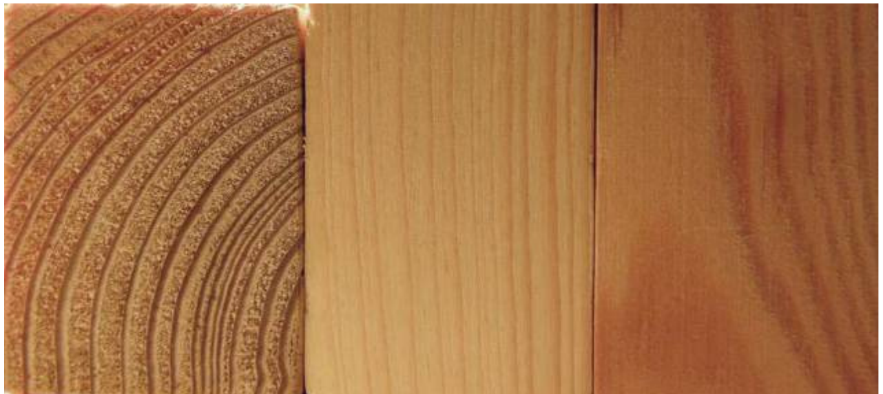
Fot. 4. Rysunek słoików rocznych na przekroju poprzecznym, promieniowym i stycznym
