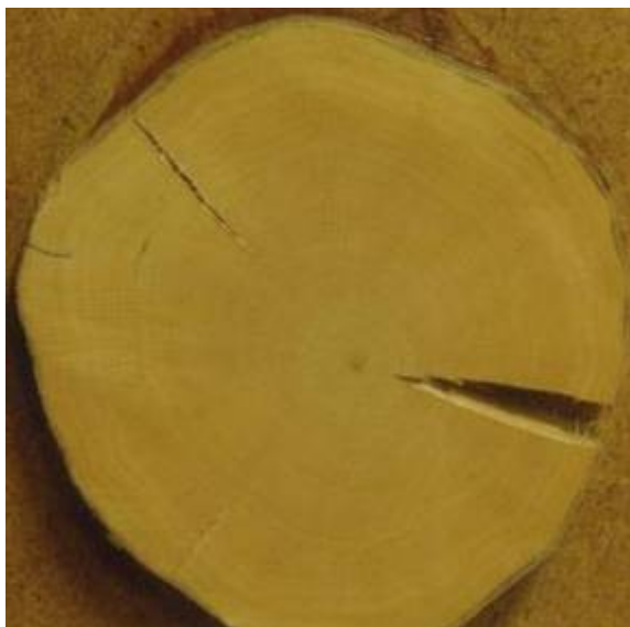
Fot. 8. Pęknięcie drewna w wyniku skurczu w kierunku stycznym do obwodu
